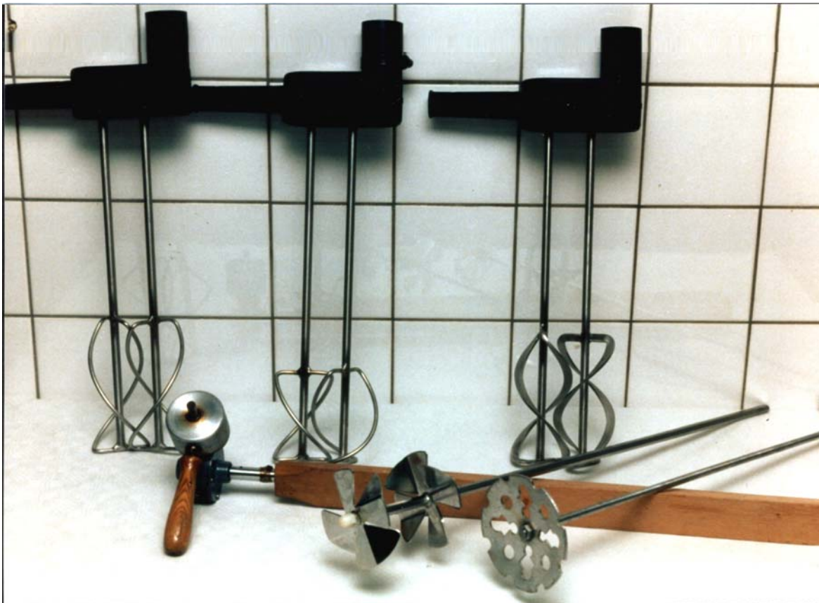
Abb. 4: Bei der Honigaufbereitung gebräuchliche Rührwerke: Dreikantiger Buchenholzstab mit Untersetzungsgetriebe, Rührstampfer, Apisolar Apirecord V4A 100, beba-Rührer (B 050-45 „Standard“ (Flachstahl), B 050-45 NRK und B 050-45 NR (Rundstahl)).
