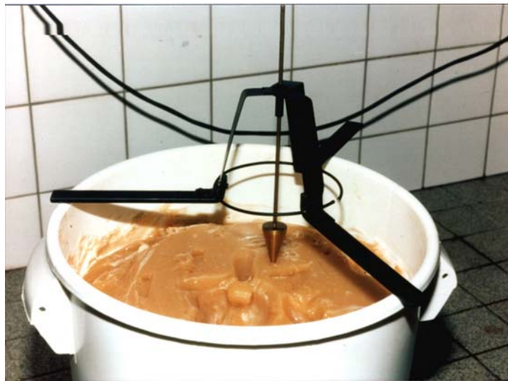
Abb. 8: Versuchsaufbau zur Messung der Viskosität mit dem Messgerät nach HANSSON (1966), Gewicht des Messing-Kegels 100 g; Honig aufgewärmt aber nicht gerührt.
