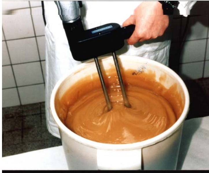
Abb. 5: beba-Rührwerk in Aktion, die Fließrichtung des Honigs ist nachvollziehbar.
